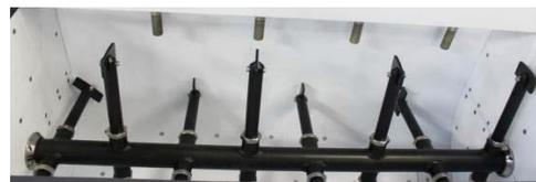
**Paletas de mezclado y eje rotatorio interior**
