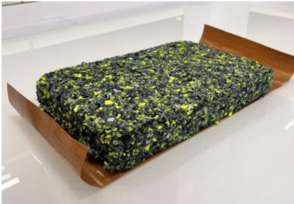
Ejemplo de bloque de compuesto polímero-partícula pre-prensa
